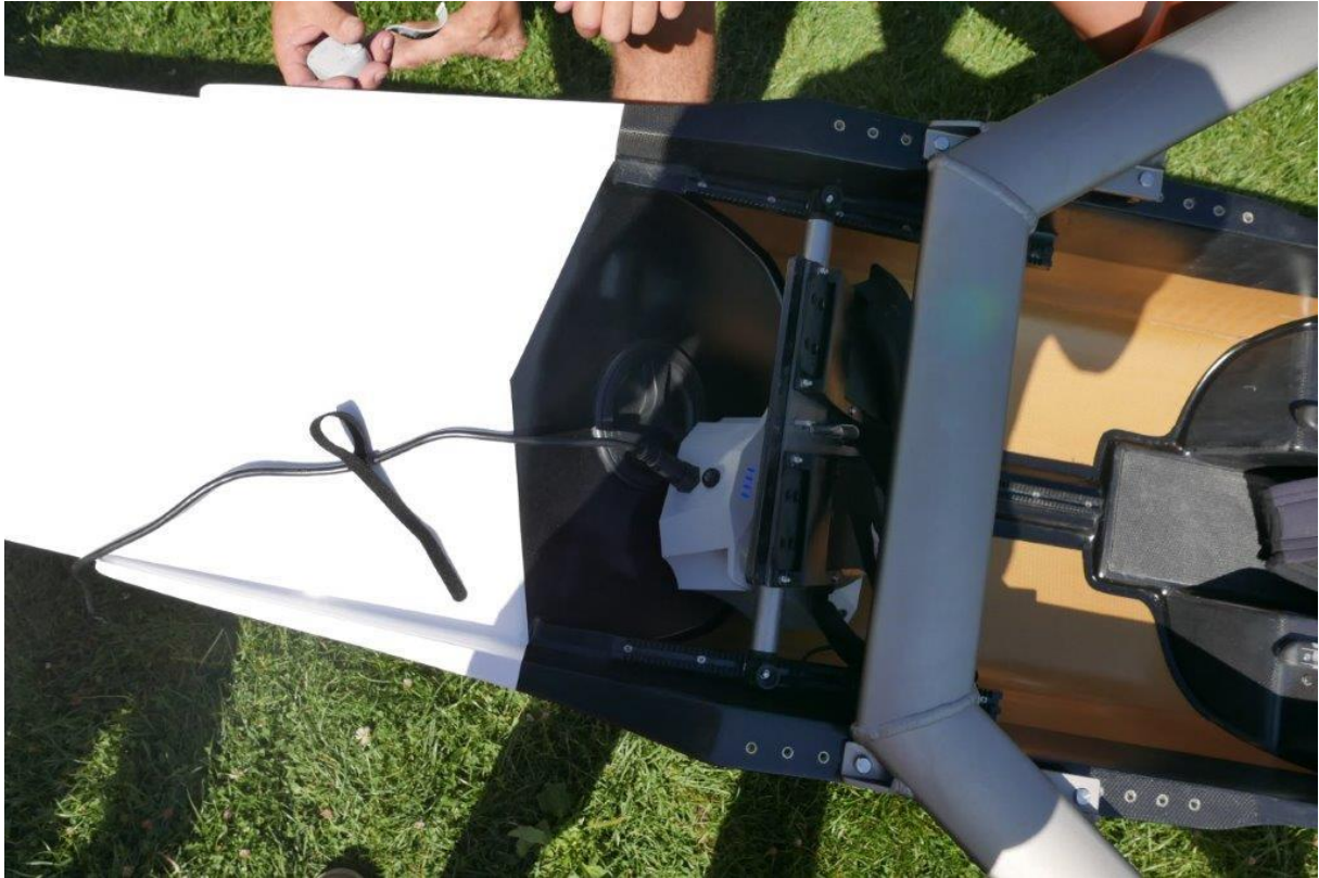
Abbildung 3 Draufsicht auf die Positionierung des Akkus im Boot
