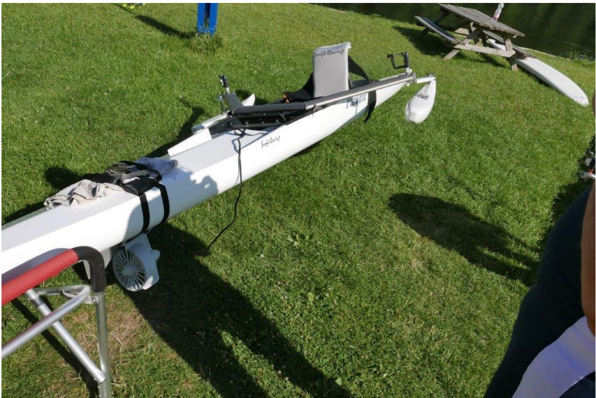
Abbildung 2 Heckansicht mit Antriebseinheit zentral im Heck des Bootes
