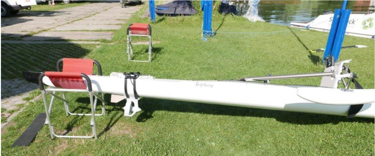
Abbildung 1 Seitansicht mit Antriebseinheit zentral im Heck des Bootes
