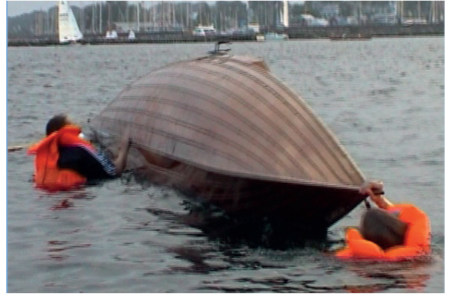
Bild 7.4b Auf das Kommando vom LStm versuchen die beiden an Bug und Heck das Boot aus dem Wasser zu heben, während der dritte das Bott wenden. In der Praxis werden die beiden ins Wasser gedrückt, aber mit kräftiger Beinarbeit und den Auftrieb der Rettungswesten wird das Boot leicht angehoben.
