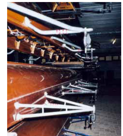
Abb.122: Aufgesteckte Isolierstücke auf den Dollenstiften verringern das Risikovo von Bootsschäden beim Einlagern und Herausnehmen der Boote.
