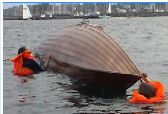
Bild 7.4b Auf das Kommando vom Steuermann versuchen die beiden an Bug und Heck das Boot aus dem Wasser zu heben, während der dritte das Bot wendet. In der Praxis werden die Beiden ins Wasser gedrückt, aber mit kräftiger Beinarbeit und den Auftrieb der Rettungswesten wird das Boot leicht angeho-
